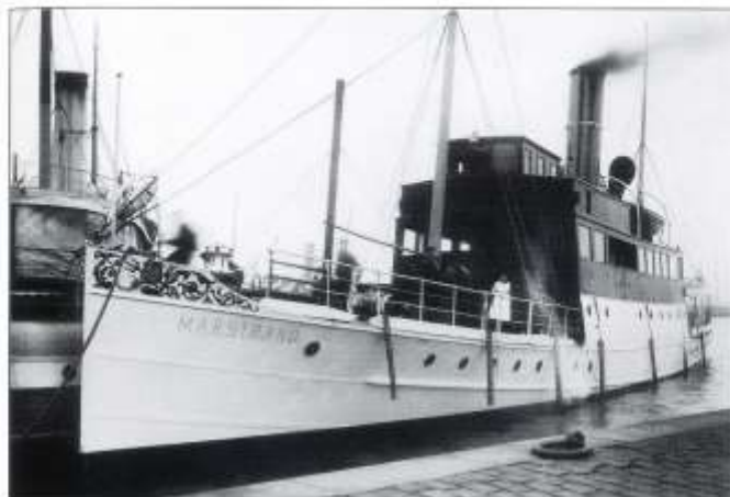
Hösten 1922 genomgick MARSTRAND en ombyggnad där kommandobryggan flyttades upp ett däck. Övre däcket byggdes in med en uträktsalong mot fronten.
